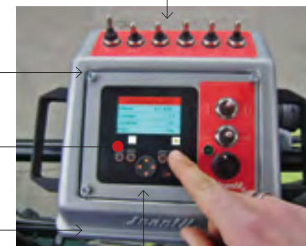
Streu-Anzeige auf SMART Control (z.B. 10t/ha, tatsächliche Streubreite 12 m)
