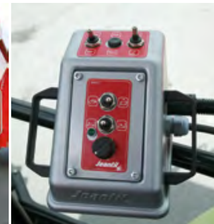
Streu-Anzeige auf SMART Control (z.B. 10t/ha, tatsächliche Streubreite 12 m)
