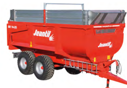
Aufbauhöhe 1.380 mm mit 600 mm hohen Aufsätzen
