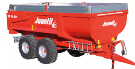
Aufbauhöhe 1.080 mm mit 300 mm hohen Aufsätzen
