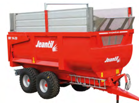
Aufbauhöhe 1.580 mm mit 900 mm hohen Aufsätzen
