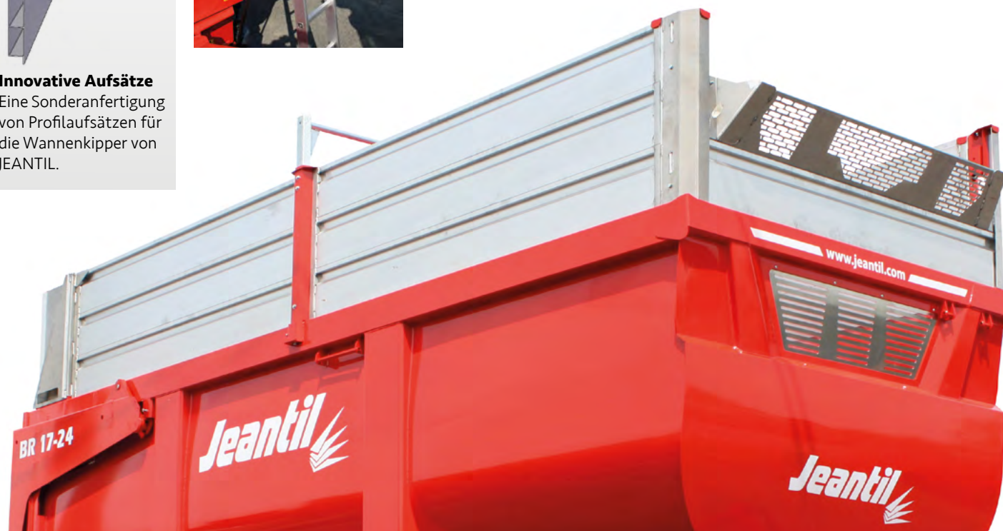
Aufbauhöhe 1.380 mm mit 600 mm hohen Aufsätzen
